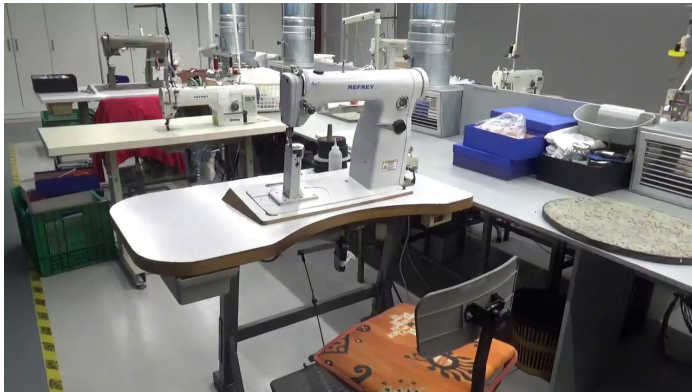
Figura 32. Disposición típica de los puestos de trabajo de aparato (máquinas de columna y planas). (fuente: estudio de campo).
