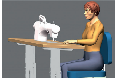
Figura 44. Mesa de trabajo regulable en inclinación.
