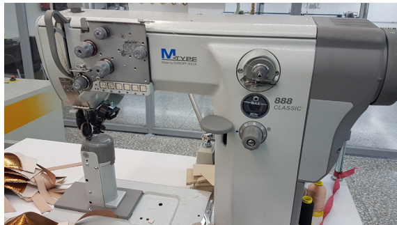
Figura 22. Máquina de aparado en columna (fuente: estudio de campo).
