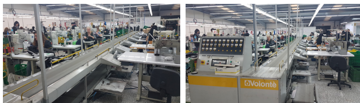
Figura 28. Cinta para el transporte/recogida de materias primas y producto terminado (fuente: estudio de campo).
