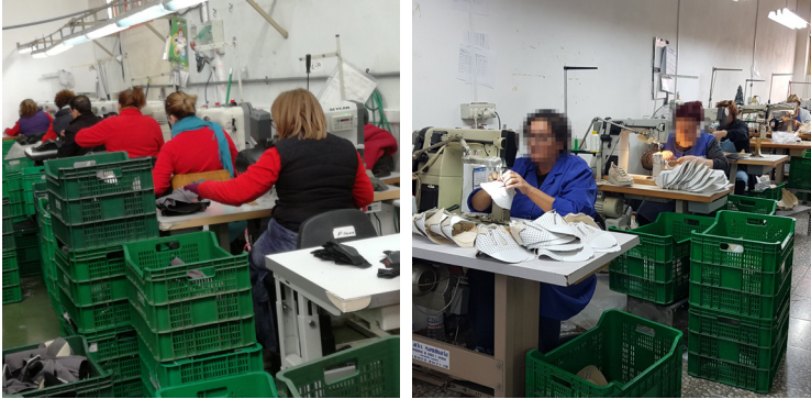
Figura 30. Disposición del puesto de aparado (fuente: estudio de campo).
