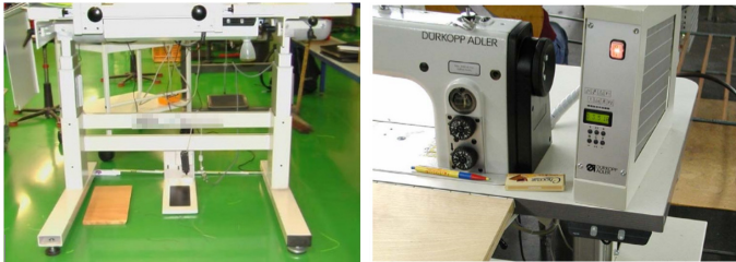
Figura 42. Mecanismo de ajuste de altura de la mesa de trabajo, y controles de ajuste.
